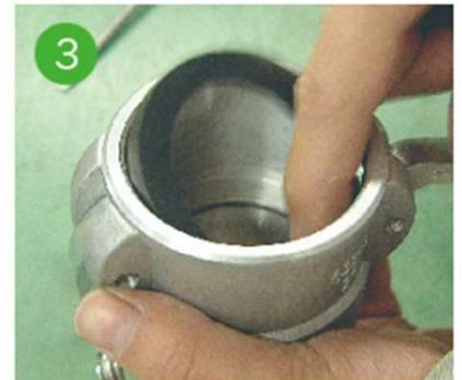
3 新しいガスケットと取換え、手で押込みます。
