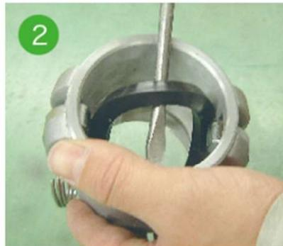
2 本体のガスケット座面を傷つけないように注意しながら、ガスケットを取り出します。
