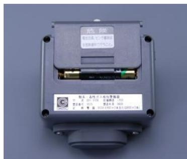
操作 9：電池蓋留めネジを締め付
