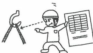
■酸やアルカリの腐食雰囲気や100°Cを超える高温雰囲気では使用しないで下さい。腐食、熱影響等により、強度が低下し、危険です。
