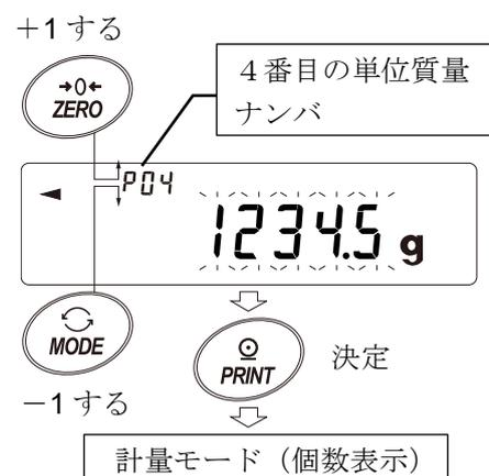
③ **PRINT** キーを押して使用する単位質量を決定し、計量モード（個数表示）へ戻ります。
