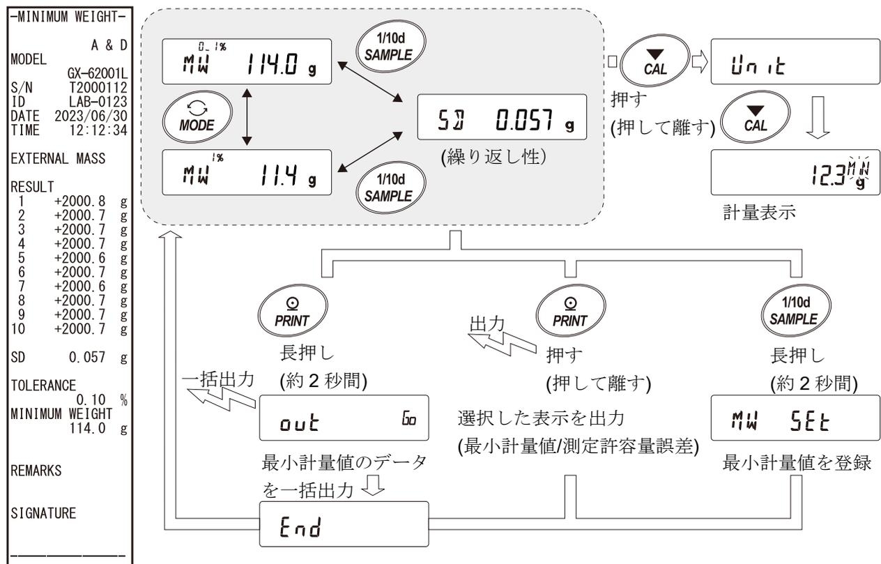
⑱ **PRINT** キーを押すと、⑰で選択した表示 (繰り返し性 (57)、最小計量値 (MW)) を出力します。
