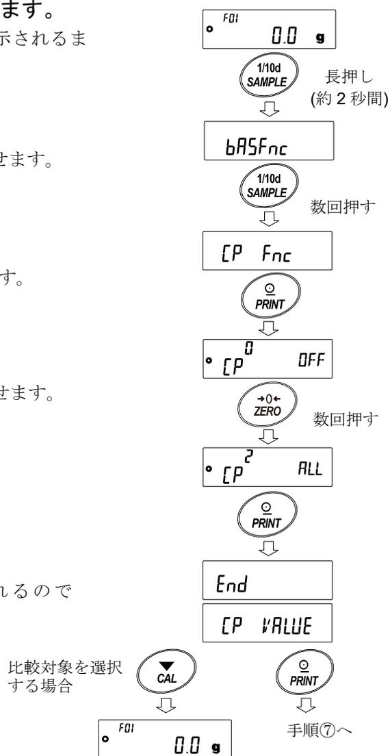
比較対象 (計量値/流量値) を選択し直す時は、**[CAL]** キーを押して計量表示に戻し、「13-4-1. 比較対象の変更」の手順を参照してください。
