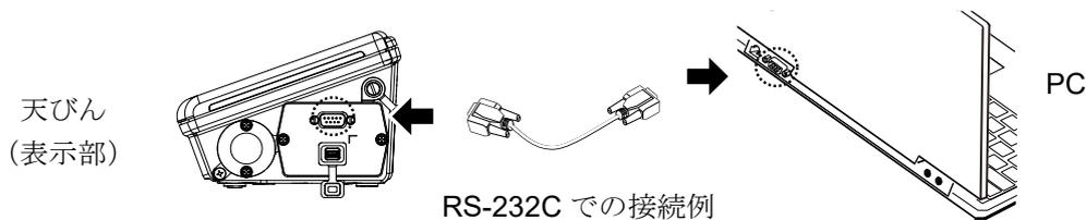
PC に RS-232C インタフェース (COM ポート) がない場合、USB コンバータ (AX-USB-9P) が利用できます。
