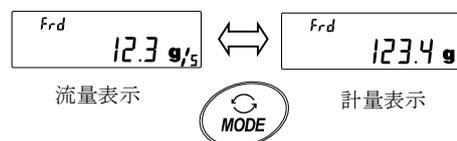
流量が安定しない場合、**SAMPLE** キーで桁blankを行うか、流量計算時間 (Ct) を長く設定してください。
