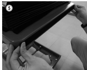
⑤ 天板の各辺に剥がしたマジックテープのメスを貼り付ける。
