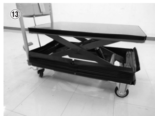
⑬ 下側取り付け後、天板へのマジックテープの取り付けをしやすいするため、ハンドリフターを下降させる。
