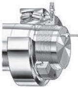
Bild 3. Einbau eines Lagers direkt auf kegeligem Sitz
