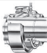
Рисунок 8. HMV гайка и стопорное кольцо в положении для сдвливания переходной втулки.
