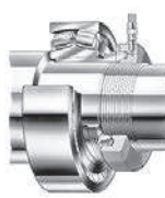
Figura 5. Porca HMV apertada no eixo para colocação numa manga de ressalto
