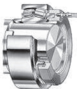
Bild 7. Herausziehen einer Abziehhülse aus einer kegeligen Lagerbohrung
