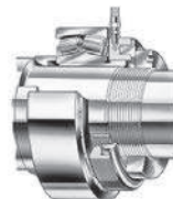
Figura 6. Porca HMV e porca de batente especial colocação numa manga de ressalto
