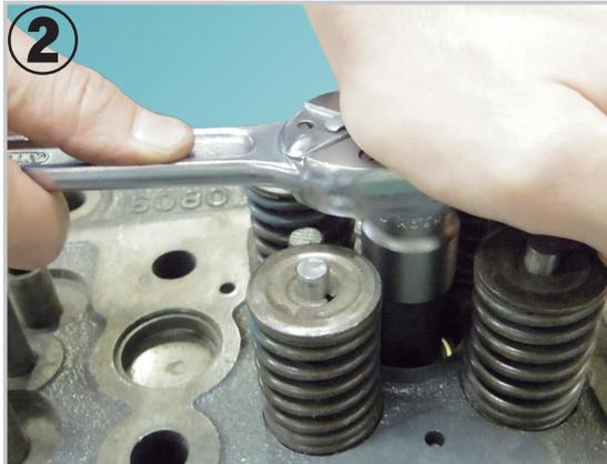
②お手持ちのラチェットハンドルとソケット (22mm) でアタッチメントを上から押さえつけながら締め込み、アタッチメントをノズルチューブにしっかりと喰い付かせます。
