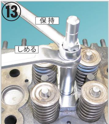
⑬ポンチをレンチで押さえながら、巻き上げナット M15 を締め込み、ポンチ A を抜き取ります。ポンチ B (目印ミツ2本) を上記同様に作業を行えばカシメ完了です。
