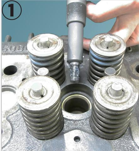
①ノズルチューブ内各部を、プラスチックハンマーでポンチなどを使用して叩き、固着を外してからアタッチメントを入れてください。
