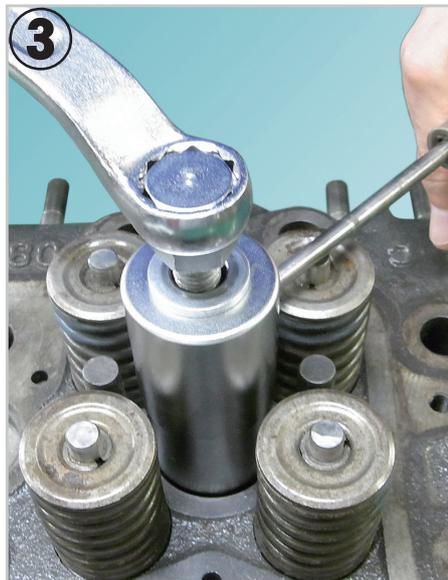
③押しボルトに、巻き上げナット M12 をいっぱいまでネジ込んでおき、座金 M12 および本体カラーに通し、チャックの六角とガイドカラー内部の六角位置を合わせながらかぶせます。本体カラーのサイド穴に、ドライバーなどを差し込み、供回りを防止しながら、押しボルトを締め込みます。
