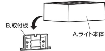
※A.ライト本体背面の固定部にB.取付板を挿し込みます。
