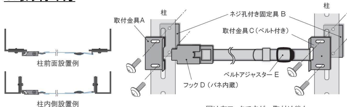
図は左フックですが、取付け後もベルトを外して左右を逆に入替えることができます。
