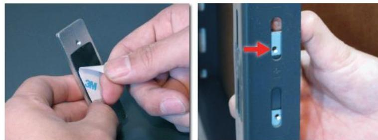
\*この際、ネジ孔付き金具Bのネジ孔部(上下共)が柱の長孔の中心になる様に注意して下さい。
