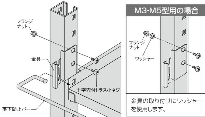
**2** バーの反対側にもう一方の金具を引っ掛け手順**1**と同様に支柱に取り付けます。
