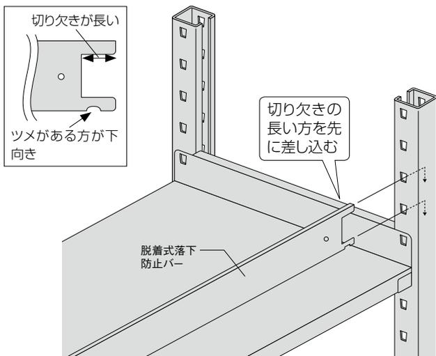
**2** 反対側のツメを支柱に引っ掛けて取り付けます。
