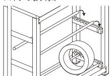
パイプ端部を中 受金具の凹部に 入れ、手前と後 方に2本取り付け ます。
