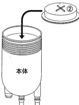
**8** カートリッジ本体に押さえ板②を指で矢印1のように押し込みながら矢印2のように下に押して、入れてください。
