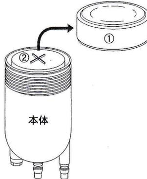
**3** カートリッジ内の押さえ板②を指で矢印1のように内側に押し込みながら矢印2のように上に持ち上げるように外します。
