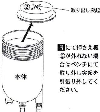
**3**にて押さえ板②が外れない場合はペンチにて取り外し突起を引張り外してください。
