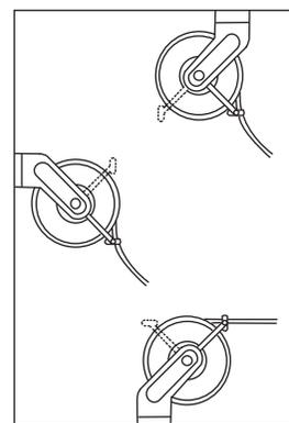
① 地面や壁面または天井の取り付けたいところにボルトでしっかりと固定してください。(下記取付寸法図参照)コンクリートの場合はアンカーボルトを使用してください。
