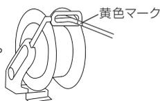
⊘ ホースの最小曲げ半径はホースの内径の6倍以上で使用し、ねじれ、折れた状態で使用しない。
