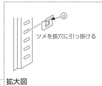
1. 本体の側板のジャバラの長穴に、棚板取付金具④のツメを引っ掛けて下さい。(4ヶ所)
