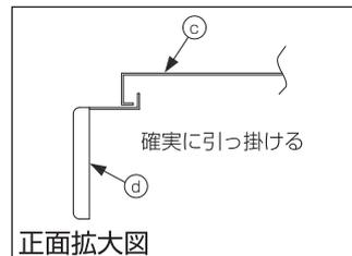
2. 1. で取付けた棚板取付金具④の上部と棚板③の下部を確実に引っ掛けて下さい。(4ヶ所)
