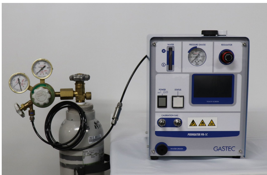
* 高圧ガス容器接続の一例
