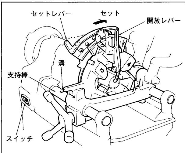
① ねじ切りサイズに合ったダイヘッドを取り付け、ダイヘッドの目盛りをねじのサイズに合わせてください。(「自動ダイヘッドの調整」14ページ参照)
