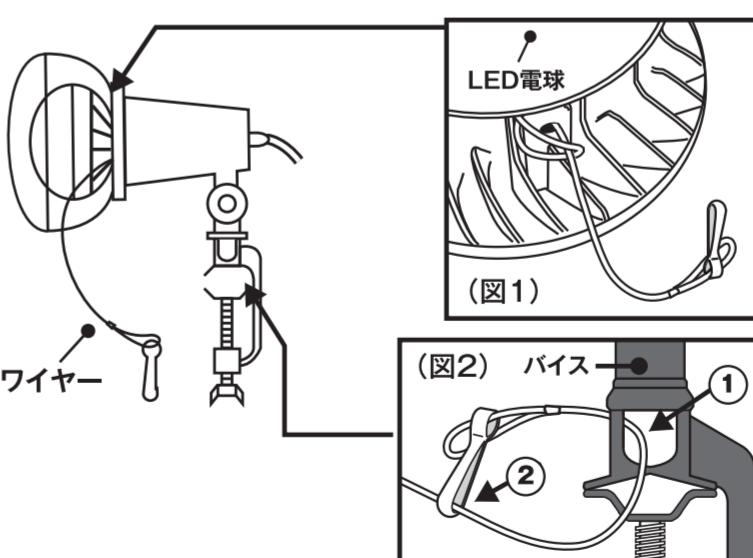
①LED電球のワイヤー取り付け穴にワイヤーのリング側を通します。(図1)
