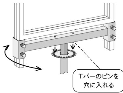
5. 本体の六角ボルトで固定して取付完了。
