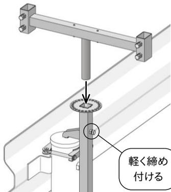
2. 畳んだ看板の脚を差し込み、Tバーの六角ボルトで固定します。
