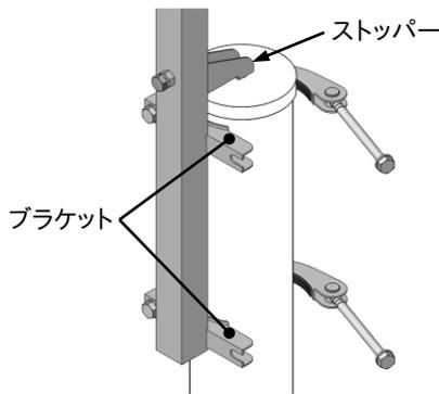
3. 押さえ金具を閉じ、上下の六角長ボルトを均等にしっかりと締め付けます。
