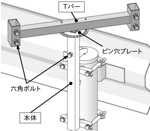
1. Tバーを本体に差し込み、本体の六角ボルトで仮締めします。
