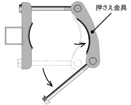
2. ガードレール支柱の頭にストッパーを載せ支柱側面にブラケットを密着させてください。
