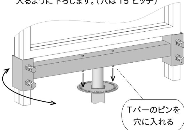
⑧ 本体の六角ボルトで固定して取付完了。(注. Tバーの高さは調整できません。)
