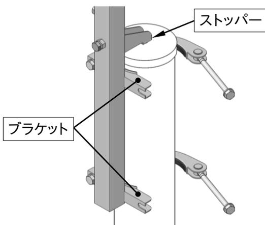
④ 押さえ金具を閉じ、上下の長ボルトを均等にしっかりと締め付けます。
