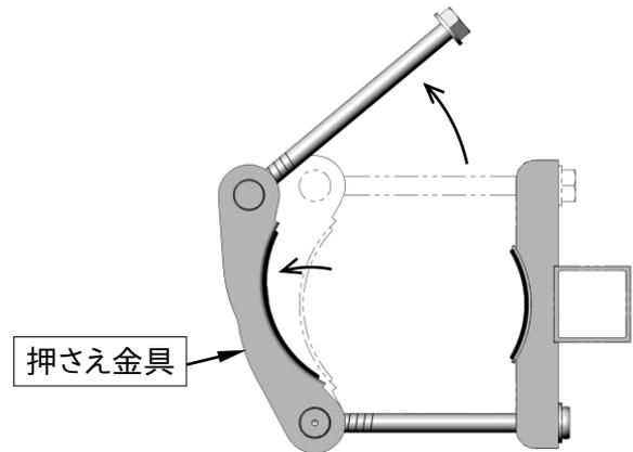
③ ガードレール支柱の頭にストッパーを載せ支柱側面にブラケットを密着させてください。
