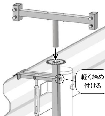
2. 置んだ看板の脚を差し込み、Tバーの六角ボルトで固定します。
