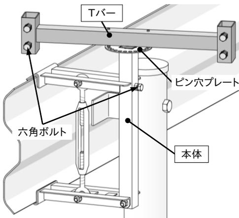
1. Tバーを本体に差し込み、本体の六角ボルトで仮締めします。
