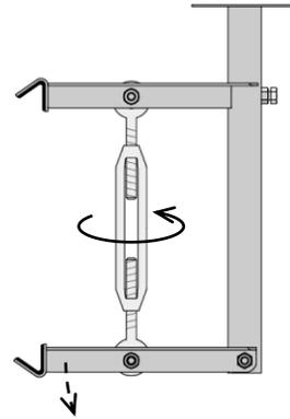
2. 上下のアームでガードレールを挟むように取り付けます。
