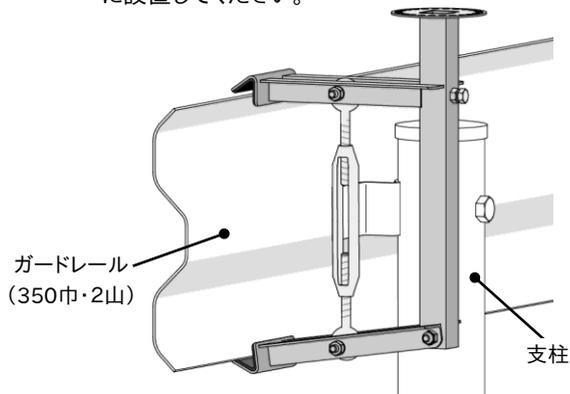
3. ターンバックルを時計回りに回し、ガードレールを確実に挟んでください。
