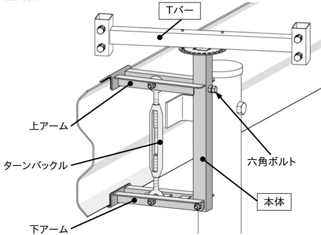
1. ターンバックルを反時計回りに回して下アームを開きます。
