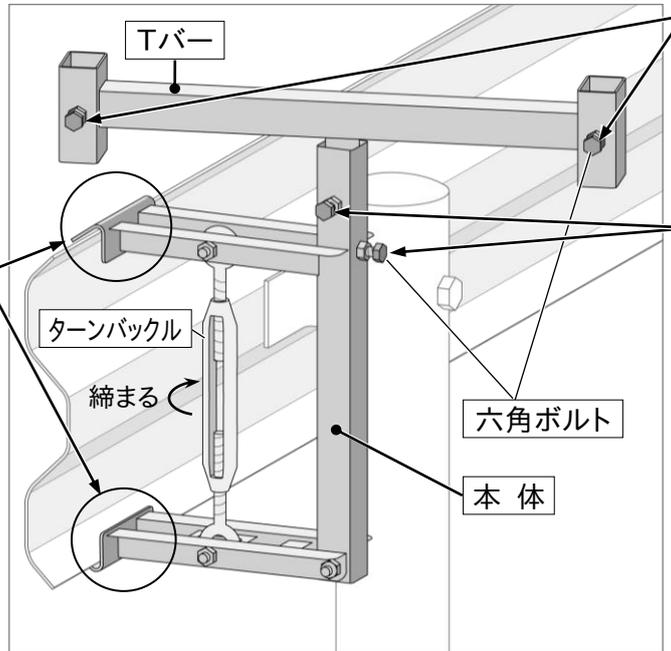
③ 畳んだ看板の脚を差し込み、六角ボルトで固定します。
