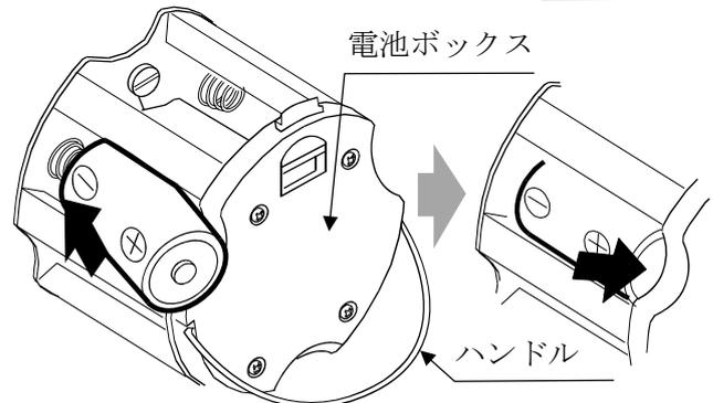
④ 「③」の要領で、極性に注意し全ての電池（計6個）を電池ボックスに装着します。
