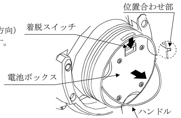
③ 電池ボックスの極性（ボックス上に表記）に注意し、乾電池の（-）側から電池ボックスに差込み、最後に乾電池の（+）側をはめ込みます。（右図参照）
