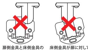
※製品は、必ず戸先から100mm以内に取り付けて下さい。吊元側への取り付けは、絶対に厳禁です。本体や周囲部材の破損につながります。
