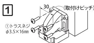
扉側本体を取り付治具の上にセットし、扉面の任意の位置に軽く押当てる。長穴（×2）を①で仮固定し、取付位置を調整します。調整後、丸穴と長穴を①でしっかりと固定してください。
