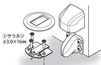
※何らかの理由で、取付治具をご使用になれない場合は、最初に床側ベースの長穴（×1）を仮固定し位置調整をしてください。調整後、3ヶ所の穴をしっかりと固定してください。
