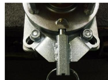
又、旋回ロック機能は地面と平行な時はピンが押し出され、旋回中自動的に溝にはまる仕組みとなっております。リングが垂直状態の時は旋回ロックが解除されている状態です。
