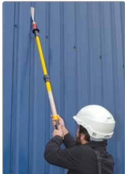
Elcometer 236には、最大出力電圧が15kVと30kVのモデルあります。どちらのモデルでも電圧と感度の設定を調節できます。
