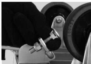
③ 調整ねじを適切な長さに調整します。
