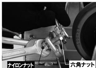
② 車輪側の六角ナットをスパナにて動かないように固定します。そしてナイロンナットをスパナで軽く緩めます。
