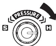
1. テープの材質・性質にあわせて、テープを押える圧力を調整してください。
