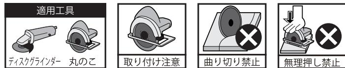
**作業環境** ●電動工具メーカー指定の保護カバー(安全カバー)を必ず正しく取り付けて下さい。刃物が破損したとき、飛散した破片が当たり大けがの危険があります。●作業の周囲状況を考慮して下さい。作業者以外は近づけないようにして下さい。刃物が破損あるいは切り粉などの破片が飛散したとき、保護カバーがあっても破片が飛び出すこともあり大けがの危険があります。●刃物は、使用中に火花を発生することがあります。引火や爆発の恐れがあるところでは使用しないで下さい。●刃物は、使用中に騒音を発生します。周囲に迷惑をかけないようご留意下さい。
