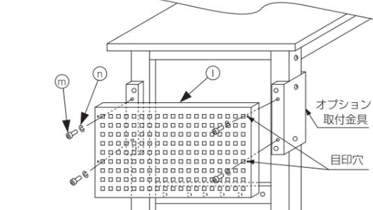
I オプション取付金具を、図-3のように取付けし、側面パネル①に開いている目印穴の隣の角穴から見たボルト穴を合わせ、六角レンチ⑤を使い、キャップボルト④とSW⑥で仮止めして下さい。(4ヶ所) 次に、仮止めしたボルトを六角レンチ⑤でしっかりと締付けて下さい。
