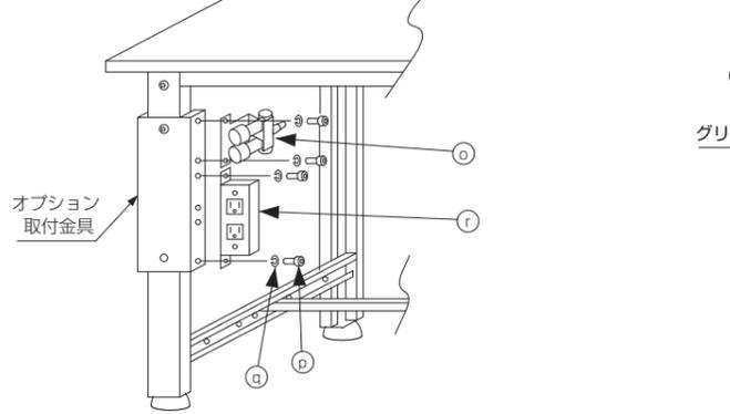
I 作業台に、オプション取付金具を任意の脚に取付けし、エア源カプラ⑦・コンセント⑩のボルト穴を合わせ、キャップボルト⑧とSW⑨を六角レンチ⑤でしっかりと締付けて下さい。(2ヶ所)
