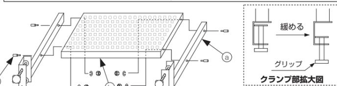
I ① 箱から支柱⑬を取り出し、グリッパを天板の厚みほど緩めて下さい。(左右各2ヶ所/拡大図で参照)
