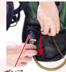
④チューブを留めている面ファスナーを外します。次にタンクを留めている面ファスナーも外してください。
