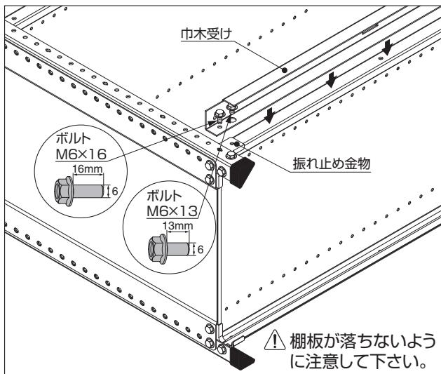
※棚を起こした状態では手を入れにくいため、シャッター取り付け側を上にして斜めに寝かせた状態で取り付けます。
