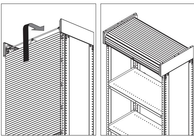
※シャッター裏面に貼り付けてある仮固定テープは⑩まで剥がさないでください。レール取り付け前に剥がすと、スラットがバラバラになってしまいます。
