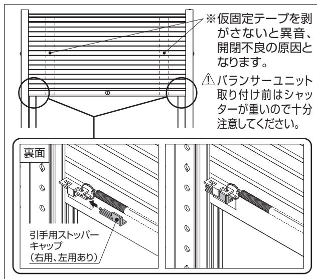
※バランスユニットには外れ止めのキャップを取付けます。
