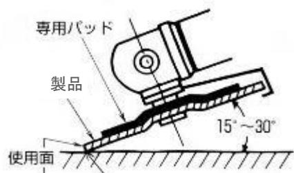
ベタ使い(研削角度15°以下)をすると変形摩耗したり、製品の破損の恐れがありますのでおやめください。
