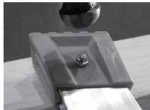
支柱端員を支柱に取り付け、アウブリベットを根元まで差し込みます。台などの上のせて、ピンをハンマーで軽く叩いて押し込んでください。
