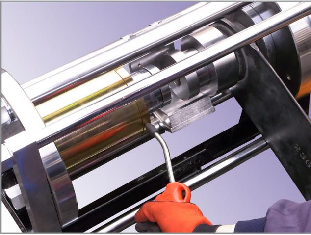
10, エアーガンで、ピストン戻し用穴に圧縮エアを吹き込み、ピストンを戻します。この時ポンプ側は、開放状態にしておいてください。ガイド以外の各アタッチメントを外します。
