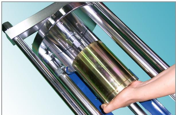
ベースをリアプレート側に移動してガイドとし、シリンダー組をカプラー側から本体枠内に通します。
