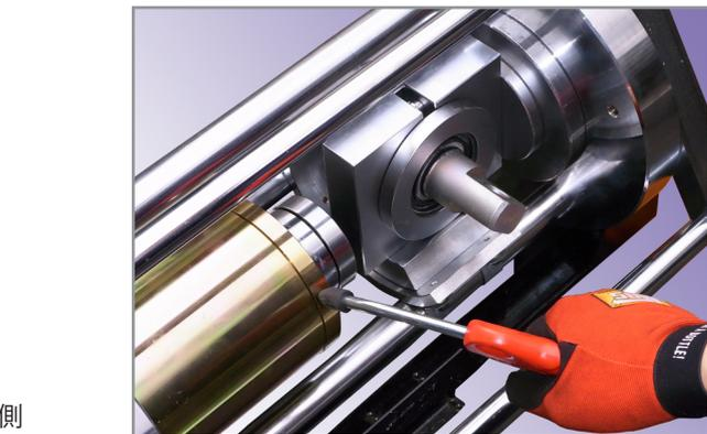
5, いったん油圧を抜き、エアガンでピストンを戻し、ブッシュコンプレッサーから圧縮されたブッシュを取り出します。
