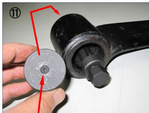
※写真のヘコミ側が表になる様に-07アタッチメントをチャック(B)の反対側からセットします。
