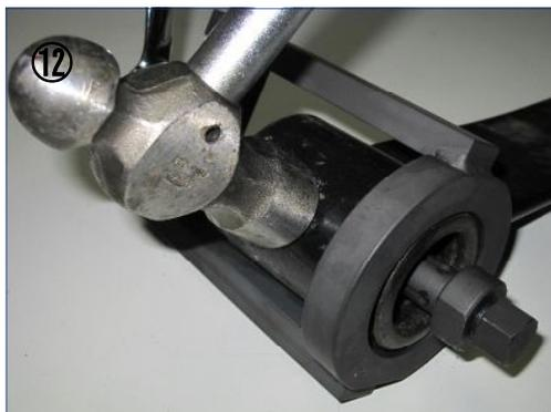
プレッシャーボルトを締め込み、カラーを押し抜きます。固着が激しい場合は、締め込みながらリーフスプリング側面にハンマーショックを加えてください。
