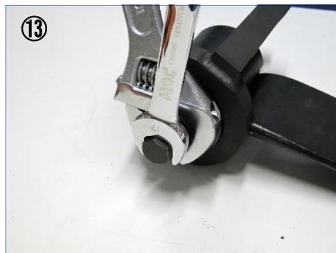
※リーフスプリング側面にハンマーショックを加えてた時は必ず再度チャック(B)と押し棒の増し締めを行ってください
