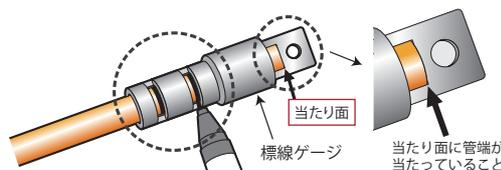
・標線ゲージに管を通し、管端面が確認窓の当たり面に当たっていることを確認した後、指定の油性マジックで標線2本をマーキングしてください。
