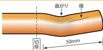
・管端から50mmの範囲で管に傷・曲がり・扁平・熱劣化・内外面への異物付着がある場合は、その箇所を切除してください。
