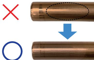
◆ただし、矯正工具による【以下の写真(a)】管端および管端から50mmを超える位置についた擦れ痕や【以下の写真(b)】管切断時のローラーカッターによる擦れ痕は、継手の性能に影響しません。
