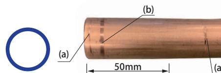
○ 矯正工具は銅管端面の楕円形状を矯正するための工具です。銅管の曲がりを矯正する工具ではありません。
