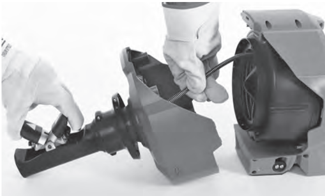
図 18 - ケーブルをドラムに送り込む
