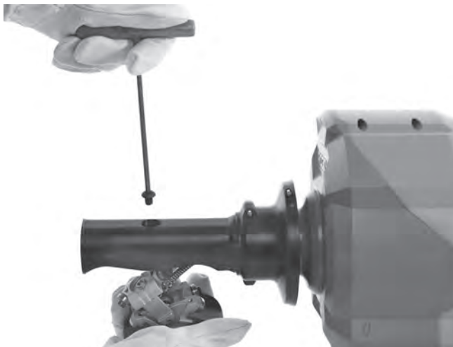
図 16A – AUTOFEED 機構を取り外す
