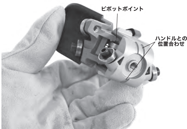
図 16B – AUTOFEED 機構
