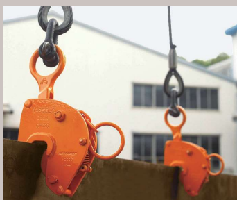
鋼板の堅吊り(2点角度吊り)
