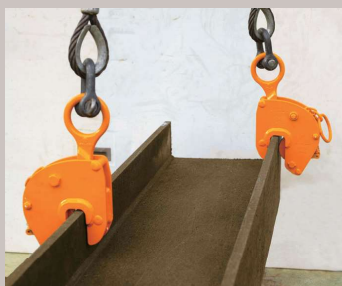
H型鋼の堅吊り(2点角度吊り)
