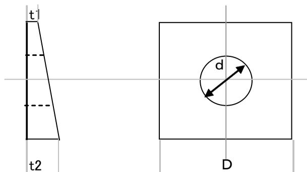
材質：一般構造用炭素鋼（S S 4 0 0）
