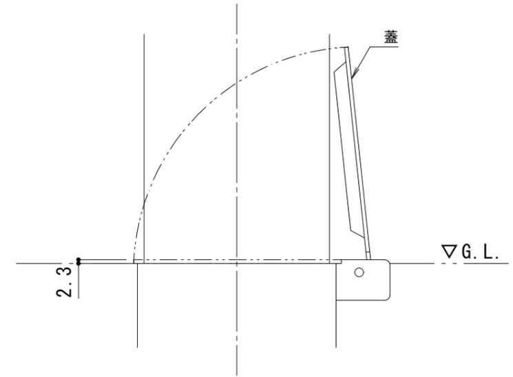
埋設管蓋部 詳細図 S = 1 : 3
