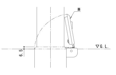
埋設管蓋部詳細図 S=1:3
