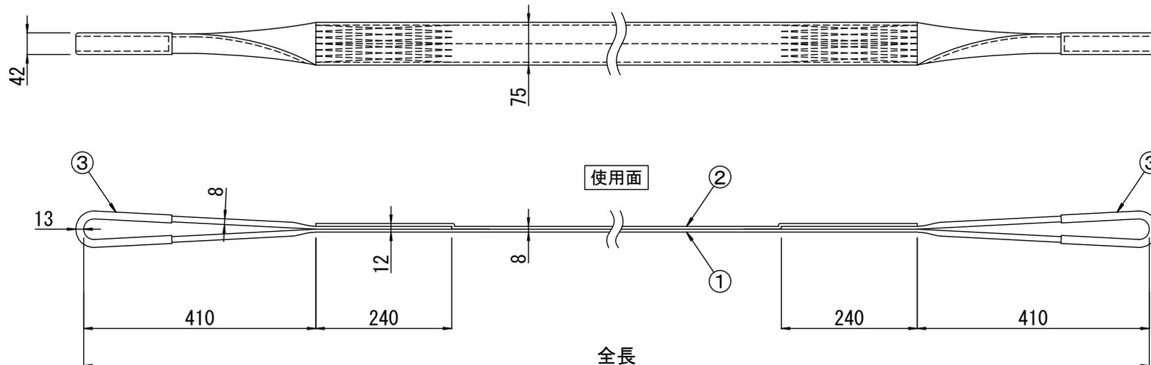
[摘要] 図中の破線 ----- は④縫糸を示す
