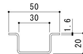
補強材詳細図 S = 1 : 2
