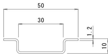
補強材詳細図 S = 1 : 1
