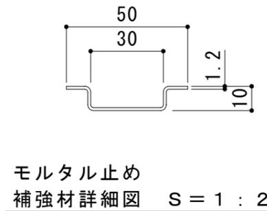
モルタル止め補強材詳細図 S = 1 : 2
