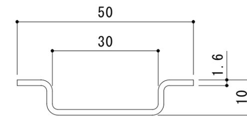
補強材詳細図 S = 1 : 1
