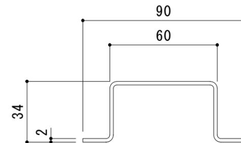
補強材詳細図 S = 1 : 2
