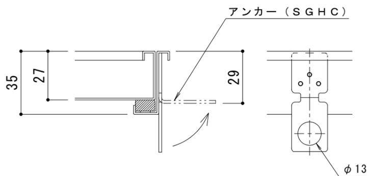
※アンカーは施工時に現場にて折り曲げて下さい
