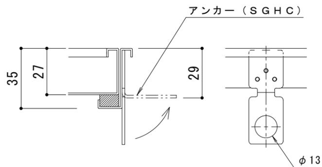
※アンカーは施工時に現場にて折り曲げて下さい
