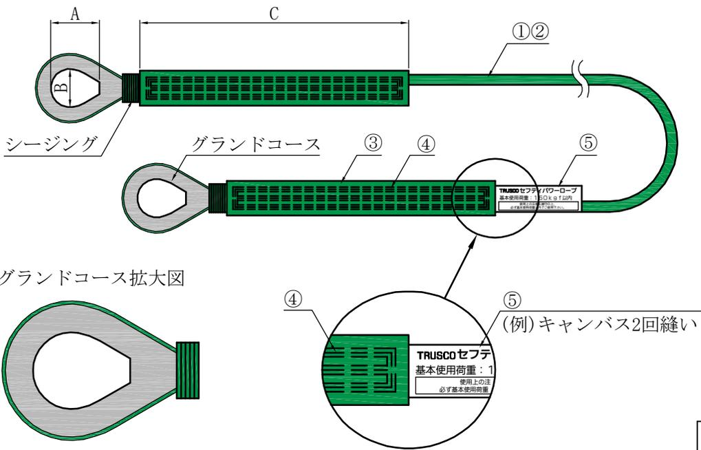
※グラントコース取り付け方法：アイ部分にコース（金具）を入れ、キャンバスとの間をシージングし、その部分を樹脂（ウレタン）コーティングする。
